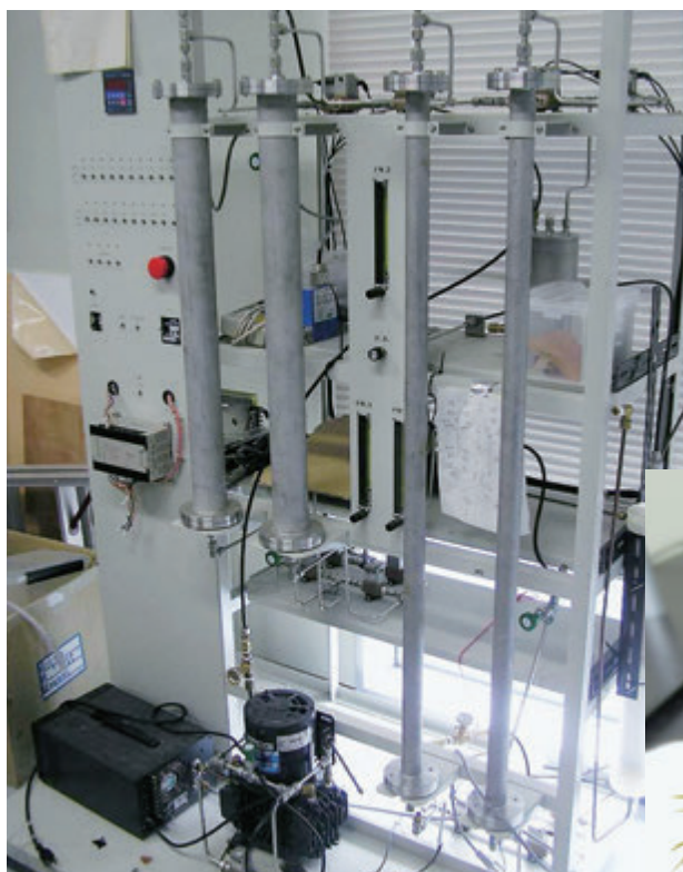
吸着式ガス分離装置
