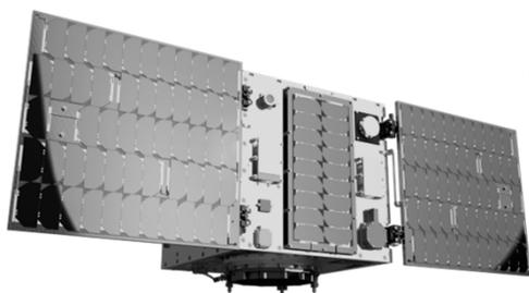
金沢大学先端宇宙理工学研究センター(ARC-SAT)が開発中の超小型科学観測衛星で、本体は50cm角の立方体、重さは約45kgです。突然強力なX線などを発生するX線突発天体を観測します。さらに2015年に史上初めて検出され大きな話題となった「重力波」の観測施設と連携することで、「重力波天文学」という新しい学問分野の創成に貢献することをめざします。X線突発現象を観測するための装置をはじめ、金沢大学で開発された機器を搭載し、2023年度の打ち上げに向け準備が進んでいます。
